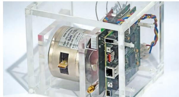
Portables Elektronenspinresonanzspektrometer, basierend auf einem CMOS-integrierten Mikrochip
