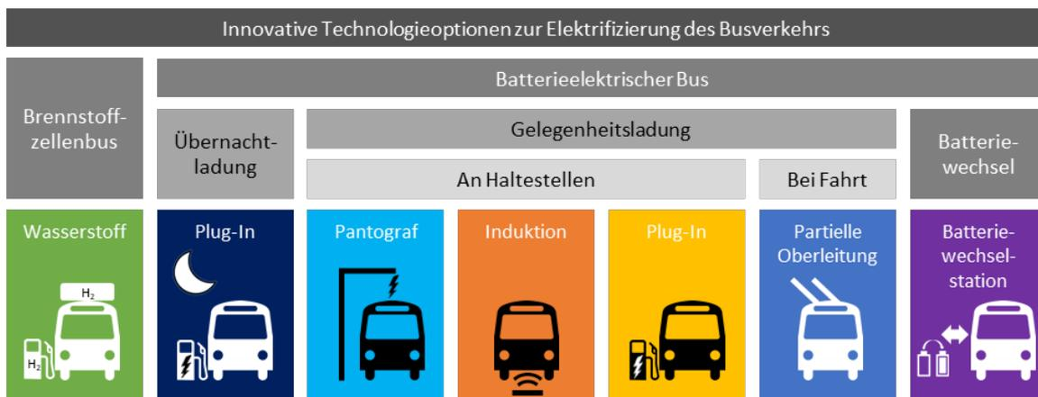
Abbildung 6-3: Übersicht innovativer Technologietypen zur Elektrifizierung des Busverkehrs [60]
