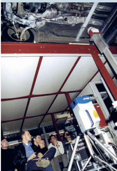
Einsatz des Scanningvibrometers an einer Abgasanlage im Motorbetrieb
