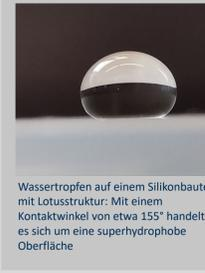
Wassertropfen auf einem Silikonbauteil mit Lotusstruktur: Mit einem Kontaktwinkel von etwa 155° handelt es sich um eine superhydrophobe Oberfläche
