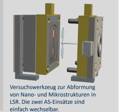
Versuchswerkzeug zur Abformung von Nano- und Mikrostrukturen in LSR. Die zwei AS-Einsätze sind einfach wechselbar.
