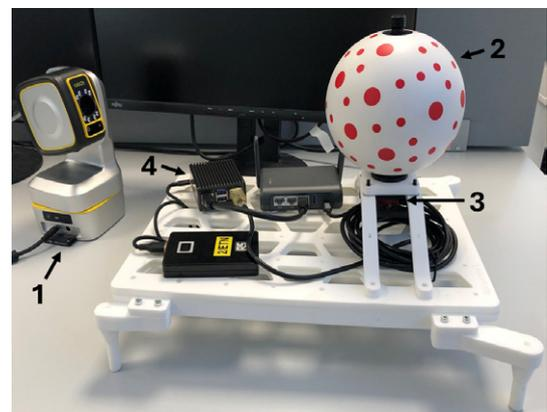
Abb. 1: Versuchsaufbau: 1: Das iCS50, 2: Leica Messkugel, 3: eine Inertial Measurement Unit (IMU) und 4: ein Raspberry Pi. Nur 1 und 2 sind für das System notwendig, während 3 und 4 der Validierung dienen. [3]
