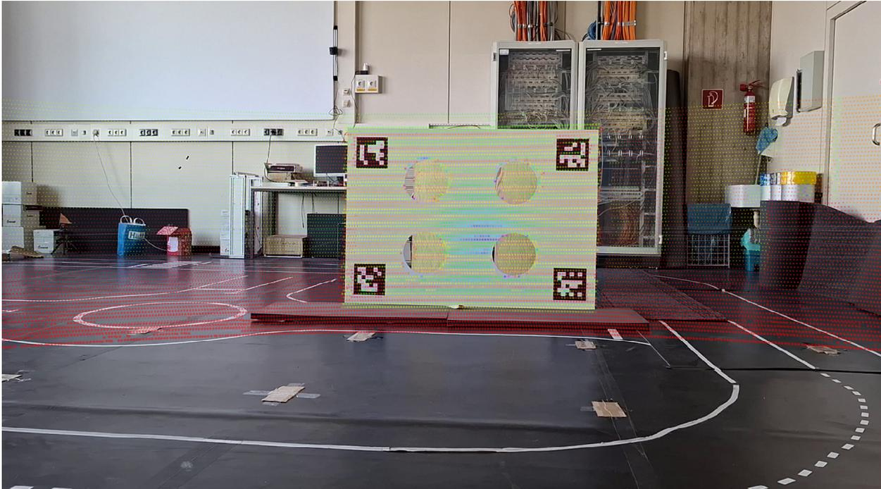
Abb. 2: RGB-Bild und LiDAR Punktwolke fusioniert [3]
