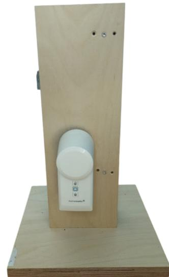
Abb. 1: Versuchsaufbau eines Türschlosses [1]
