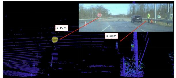
Abb. 2: Lidar Punktwolke bei Regen [3]
