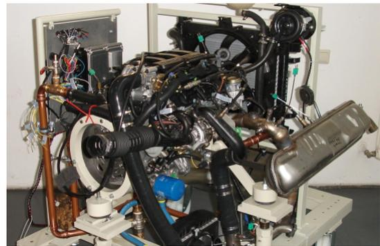
Abbildung 2: Smart-3-Zylinder-Motor M160 (Fortwo Coupe, 699cm<sup>3</sup>, 75PS)
