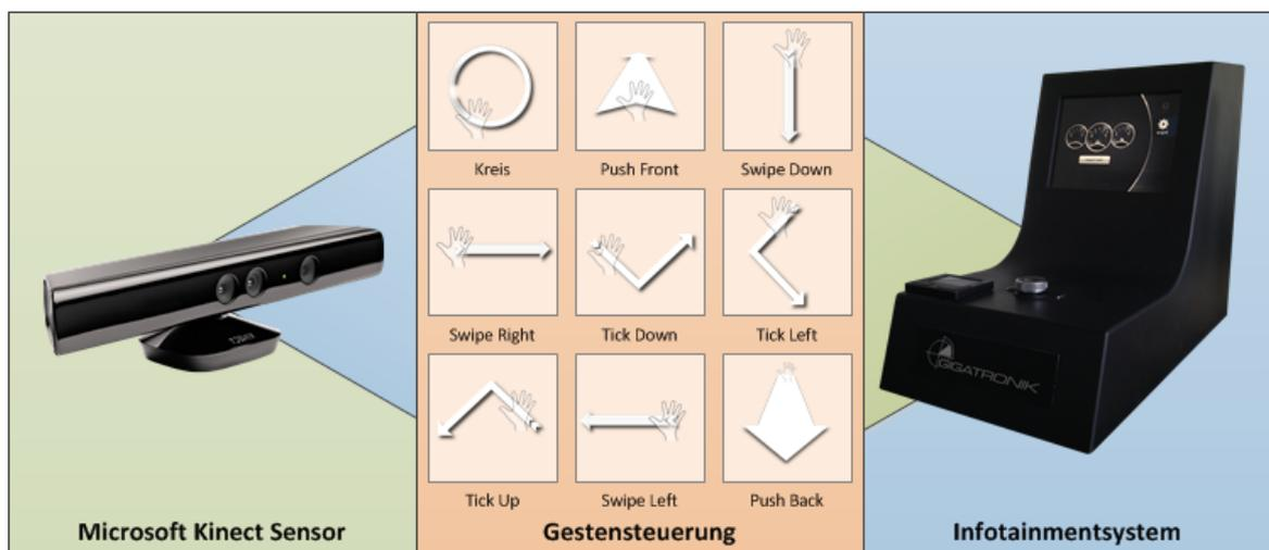
Abbildung 1: Gestensteuerung mit der Kinect für ein Infotainmentsystem
