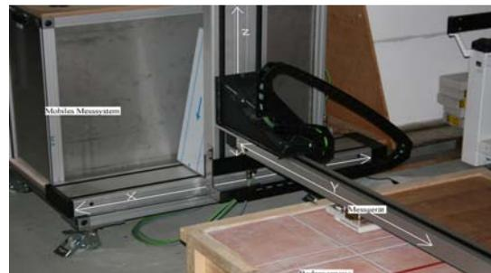
Abbildung 2: Mobiles Messsystem (3 Linearachsen)
