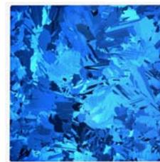
Abbildung 3: Multikristalliner Solarwafer
