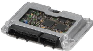
Abbildung 1: Steuergerät
