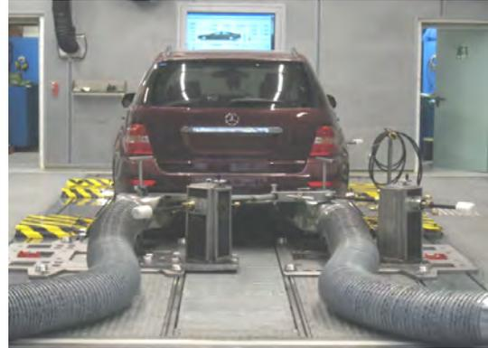
Abbildung 1: Rollenprüfstand, Daimler AG Sindelfingen
