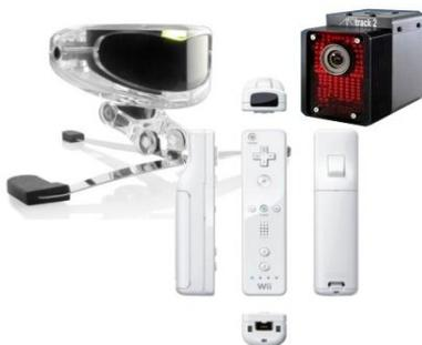
Abbildung 1: Mehrere optische Tracker TrackIR, wiiMote, Firma ART
