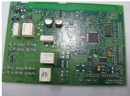
Figure 1 : Body Control Module
