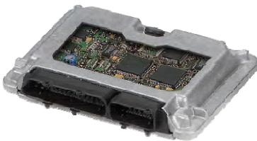
Abbildung 1: Steuergerät
