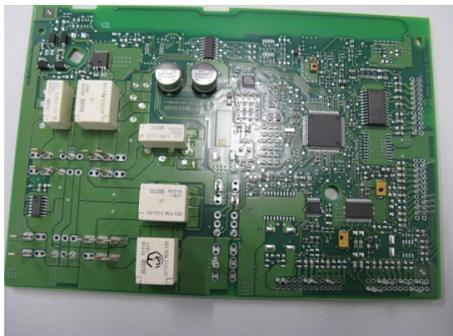
Figure 1 : Body Control Module
