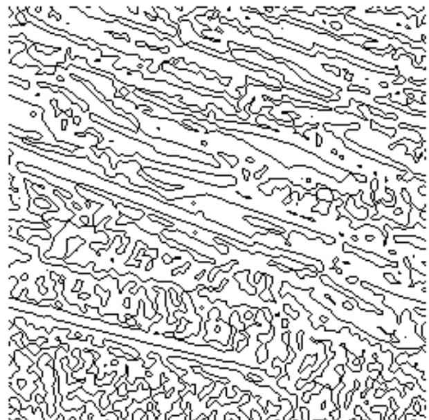
Abbildung 2: Detektierte Kanten (Nullstellen) in der Antwort des Differentialoperators
