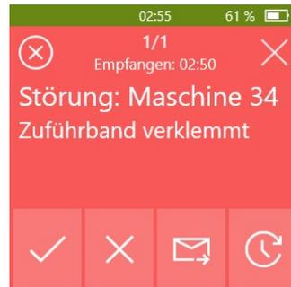
Abbildung 1: Störmeldung mit vordefinierten Antwortmöglichkeiten
