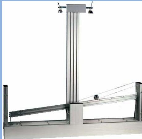
**Abbildung 1: Ball-Wippe-System der Firma Amira**
