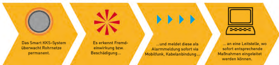
Abbildung 1: Funktionsprinzip des SmartKKS-System
