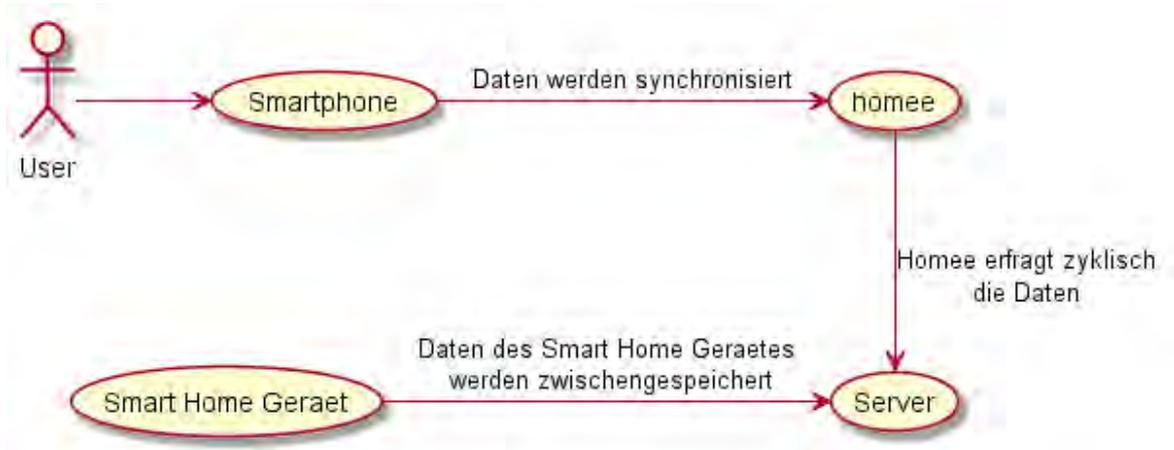
Abbildung 2: Schnittstellen zwischen User und einem Smart Home Gerät
