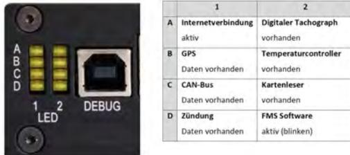
Abbildung 2: Frontseite Telematikeinheit LED's mit Beschreibung
