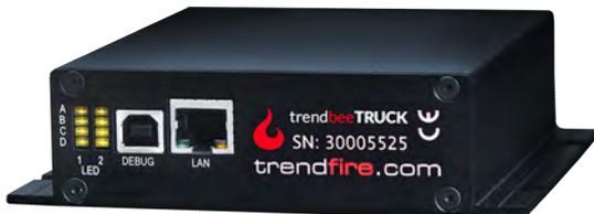
Abbildung 1: Telematikeinheit von Trendfire
