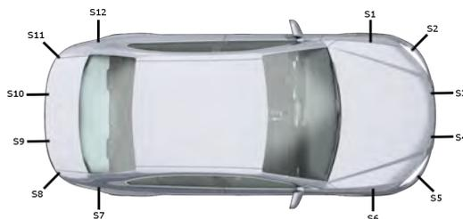
Abbildung 1: Skizze Versuchsträger mit Ultraschallsensorpositionen
