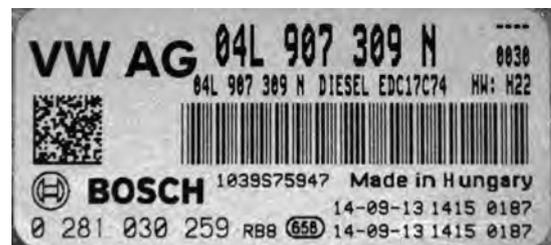
Abbildung 2: Produktlabel eines Steuergeräts
