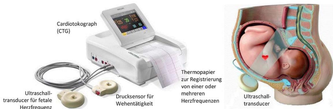
Abbildung 1: Cardiotokograph mit Aufnehmern (links), Ultraschalltransducer im Einsatz (rechts)
