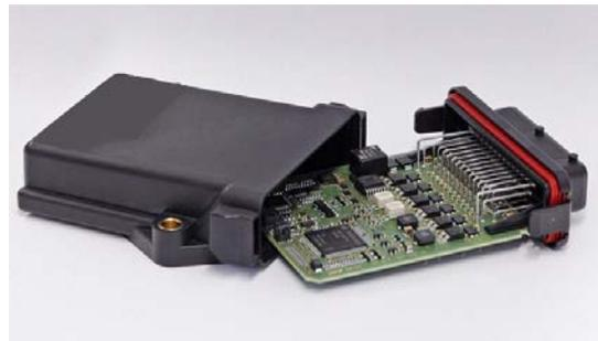
Abbildung 2: Tank Control Unit
