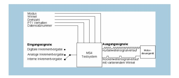
Um eine verbesserte Fahrdynamik zu erzielen, erweitert man die Motorsteuergeräte von Kfz-Fahrzeugen immer wieder mit neuen Funktionalitäten, wie z.B. Drehmomentoptimierung oder Abgasnachbehandlung. Die ausgerechneten Einspritzzeitpunkte dieser Funktionen hängen von der aktuellen Lage der Kurbel- und Nockenwelle ab. Um die aktuelle Phasenlage der Wellen zu erhalten, wertet man das Signal eines Induktivgebers aus, welcher das gewünschte Geberrad abtastet.
