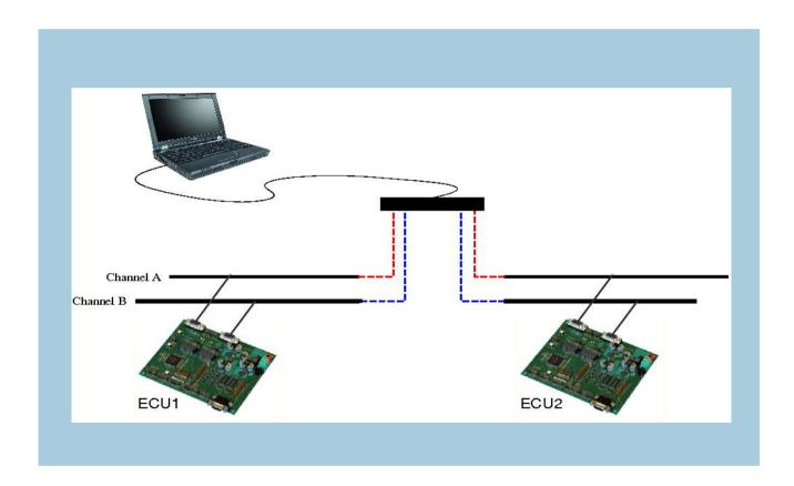
Die steigende Anzahl elektronischer Komponenten und Steuergeräte in Fahrzeugen setzt hohe Anforderungen an den Fahrzeugbus. Der CAN Bus stößt hier langsam an seine Grenzen. FlexRay bietet eine höhere Bandbreite und erfüllt die Bedingungen zukünftiger X-by Wire Entwicklungen schon heute.
