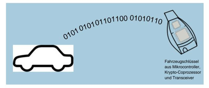
Ein Trend zu immer komplexeren Fahrzeugschlüssel ist zu verzeichnen. Automobilhersteller möchten durch die funktionale Erweiterung der Schlüssel neue Komfortmöglichkeiten für den Kunden erschließen. Man denke dabei an die Steuerung der Klimafunktionen des Fahrzeugs aus der Entfernung oder die Anzeige von Zustandsinformation wie Tankinhalt oder Standzeit.
