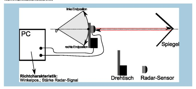
Zur Adaptiven Fahrgeschwindigkeitsregelung (ACC) werden in Automobilen Long-Range-Radar-Sensoren (LRR) eingesetzt. Diese Sensoren messen unter Anderem den Abstand zu vorausfahrenden Fahrzeugen mit Radarwellen, um z.B. einen gewünschten Abstand, einzuhalten.
