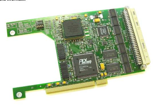
Auf Basis eines Motorola PowerPC-Prozessors wurde von der Firma SMART Electronic Development GmbH eine PCI-Einsteckkarte entwickelt. Diese Karte kann im einfachsten Fall als CAN-Kommunikationsinterface eingesetzt werden, dank des rechenstarken Mikrocontrollers ist auch die Verwendung für Simulationsanwendungen denkbar. Basierend auf dieser Karte wurden inzwischen unterschiedliche Projekte im Rahmen von Diplom- und Semesterarbeiten durchgeführt, jedoch kein serienreifes Produkt entwickelt.
