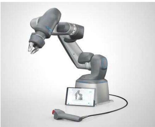
Abb. 1: Pneumatischer Cobot der Fa. Festo [3]
