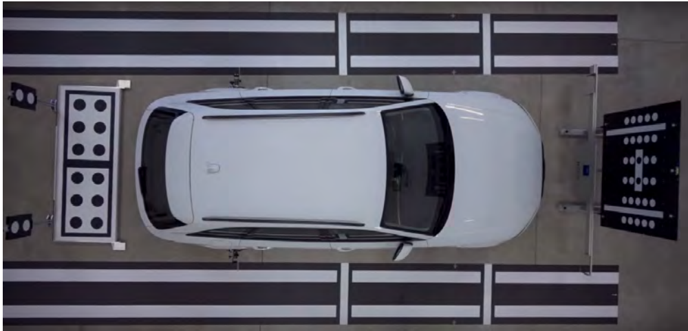
Abb. 2: Beispielhafte Anordnung von Kalibriertargets an einer Kalibrierstation [3]
