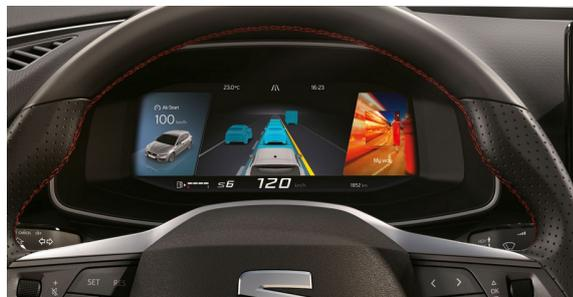
Abb. 1: SEAT Travelassist: Umfeldkarte im Kombiinstrument [2]
