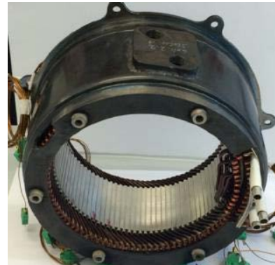
Radialflussmaschine der Robert Bosch GmbH als FEM-Modell(li) und reales Bauteil(re) [1]
