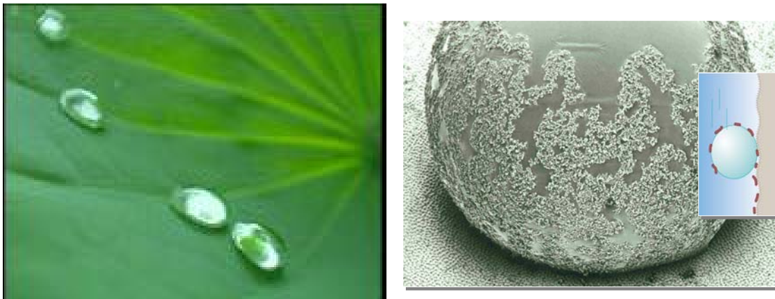
Abbildung 13-7: Lotusblatt (links) und abperlender, mit Schmutz beladener Wassertropfen (rechts) Bilder: STO AG
