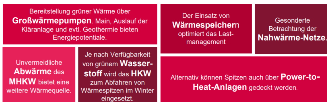
Bild 6: Beispiele von technischen Optionen bei der künftigen Wärmeleitplanung der Stadt Würzburg: (Bild: Stadtwerke Würzburg AG)
