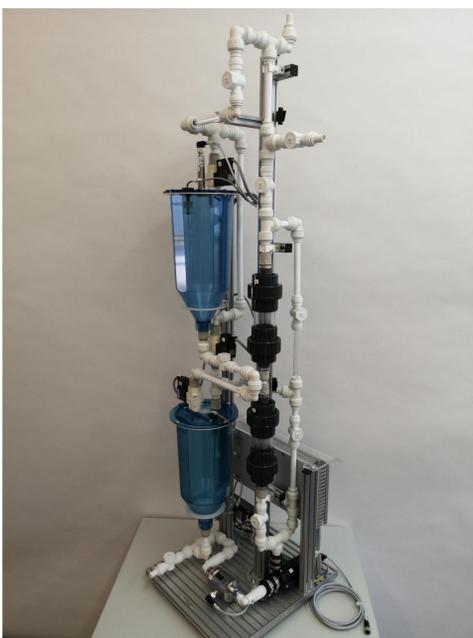
Abbildung 1 zeigt die EDS® Adsorptionsstation. EDS® steht für Environmental Discovery System. Hierbei handelt es sich um eine Reihe von Lernsystemen im anthropogenen Wasserkreislauf. Hier stehen einzelne Prozesse wie das Fördern und Speichern von Trinkwasser und das Reinigen von Abwasser im Fokus. Die Station links im Bild befasst sich mit der Spurenstoffentfernung aus Abwässern mittels Aktivkohle.
