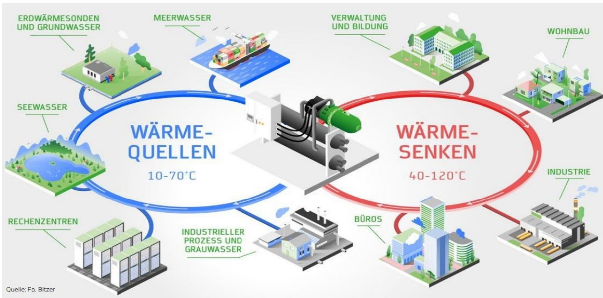
Bild 3: Wärmequellen und Senken von Wärmepumpen (Bildquelle: Bitzer SE Kälte- und Klimatechnik)
